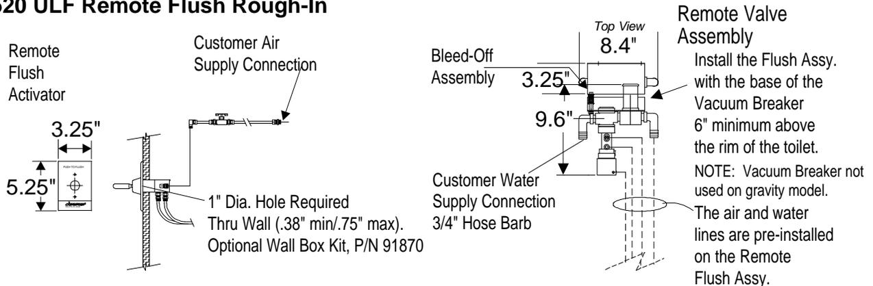
THE MAXIMUM WATER LINE DISTANCE BETWEEN THE TOILET AND THE REMOTE FLUSH ASSY IS SIX (6) FEET
